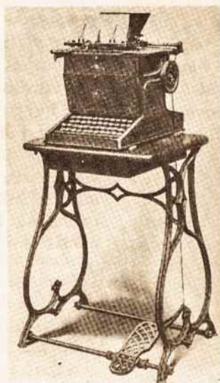
Sholes and Glidden 1873 metų rašomoji mašinėle, pagaminta Remington b-vės. Raidžių išdėstymas toks pat kaip ir dabartinių mašinėlių
