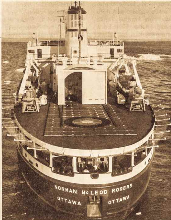
Pav. 1. Ledlaužis „Norman McLeod Roger“ su platforma helikopteriui, užpakalyje matyti „teleskopinis“ garažas sustumtoje padėtyje.
