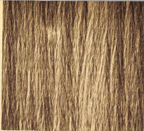
PG medžiagos grūdelinė struktūra 25 kartus padidintame skerspūvyje
